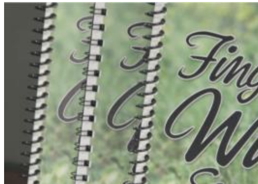
Perforatore GBC – esempio di finitura con fori per spiratura da eseguire con un altro dispositivo di finitura fuori linea
