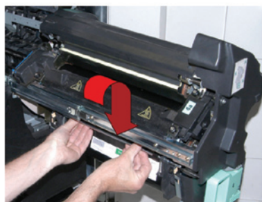
Figura 7 Fissare l'asta della maniglia della bobina nelle fessure della cornice del fusore
